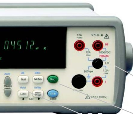
把测试线接到输入端，就可开始您的测量。
