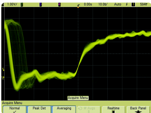
图 5. Agilent 6000 系列示波器的 256 级亮度显示出抖动、噪声和信号异常
