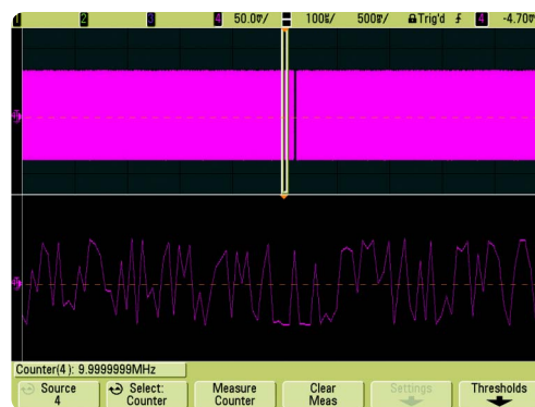
图13. 内置硬件计数器用外部10MHz参考输入进行8位的频率测量。
