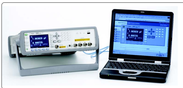
图 12. 用计算机和网络浏览器在 LAN 上方便地控制 E4980A LCR
