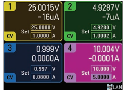
图3. 您可在 Meter View 中同时观看所有 4 路输出，它显示每一路输出电压和电流的测量值和设置值
