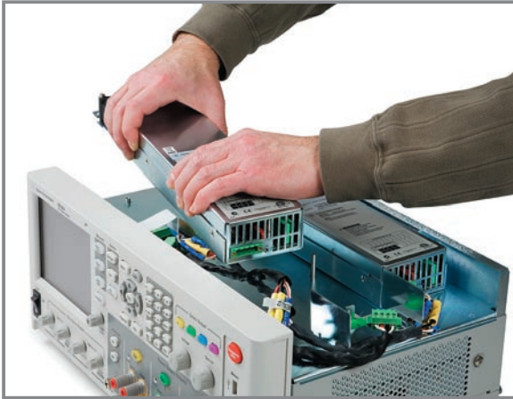
图2. 容易地将直流电源模块装入 N6705A 直流电源分析仪主机中
