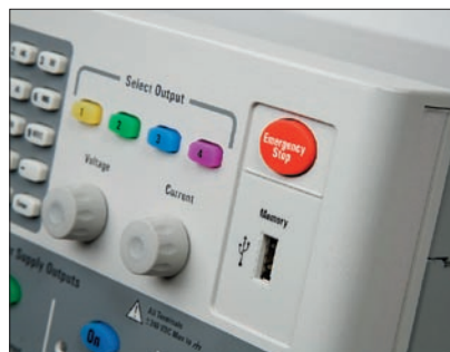
图13. 紧急停止按钮立即断开所有输出
