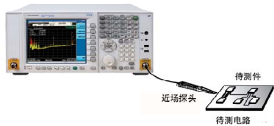
图五使用近场探头进行EMI故障诊断
