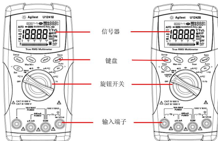
图 1-1 U1241B 和 U1242B 手持式数字万用表的前面板
