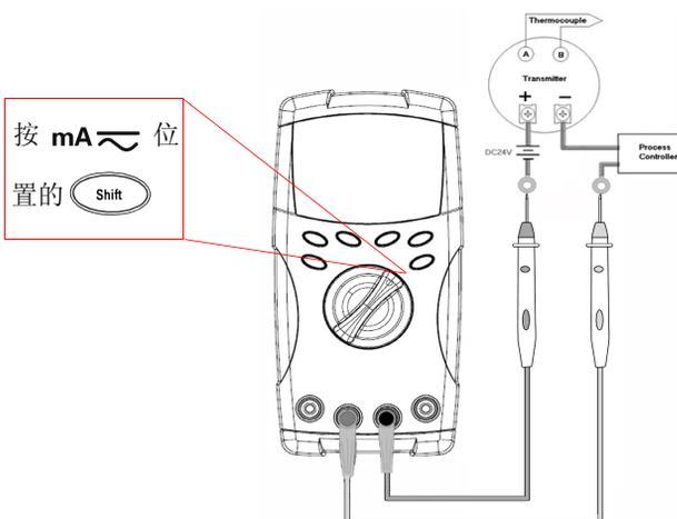
可在设置模式中选择 0 – 20 mA 或 4 – 20 mA 的百分比刻度。4-20 mA% 刻度或 0-20 mA% 刻度显示在主显示屏上，条形图表示电流值。25% 刻度读数表示 DC 8 mA（百分比刻度为 4-20 mA 时）和 DC 5 mA（百分比刻度为 0-20 mA 时）。
