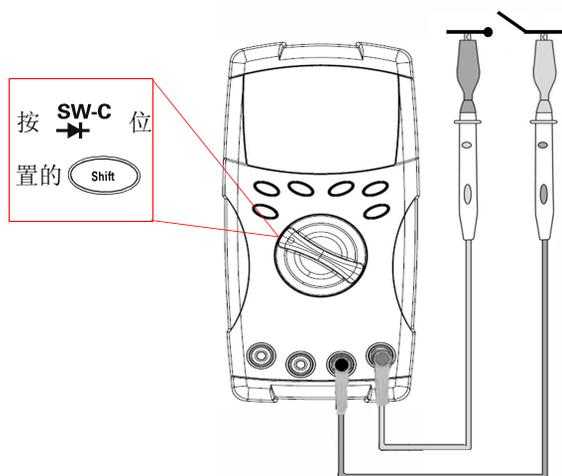
开关计数器用于检查开关、继电器或按钮的开 / 关状态。万用表提供 10 和 100 秒的时基，或用户定义的时基。
