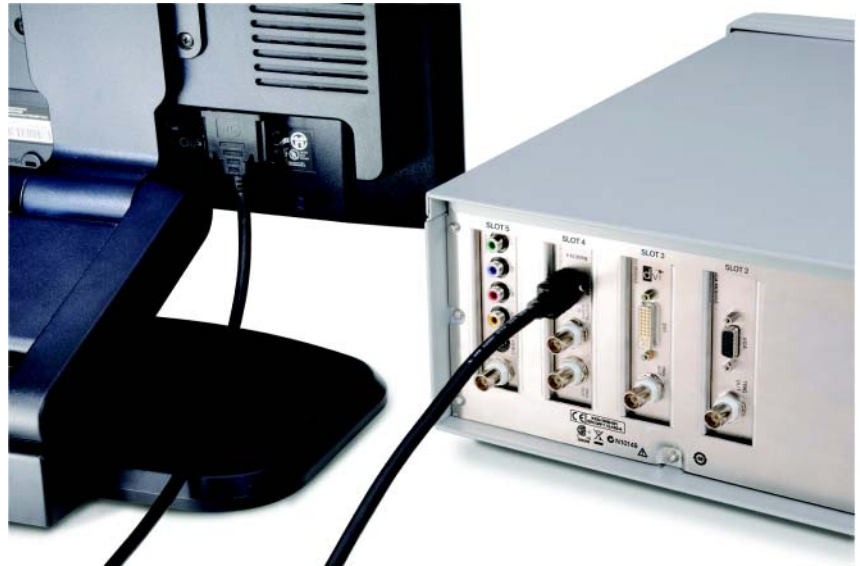
图 5. U8101A 支持通用的 DV1 1.0 和 HDMI 1.2 标准, 包括可编程 TDMS 输出信号
