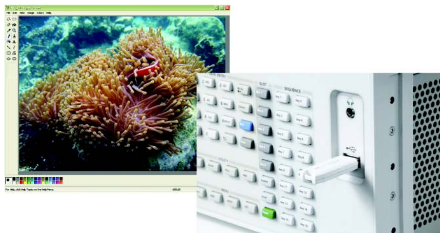
图 3. 通用 PC 接口与 USB U 盘进行自定义码型/图像、EDID、固件升级和文件的传输
