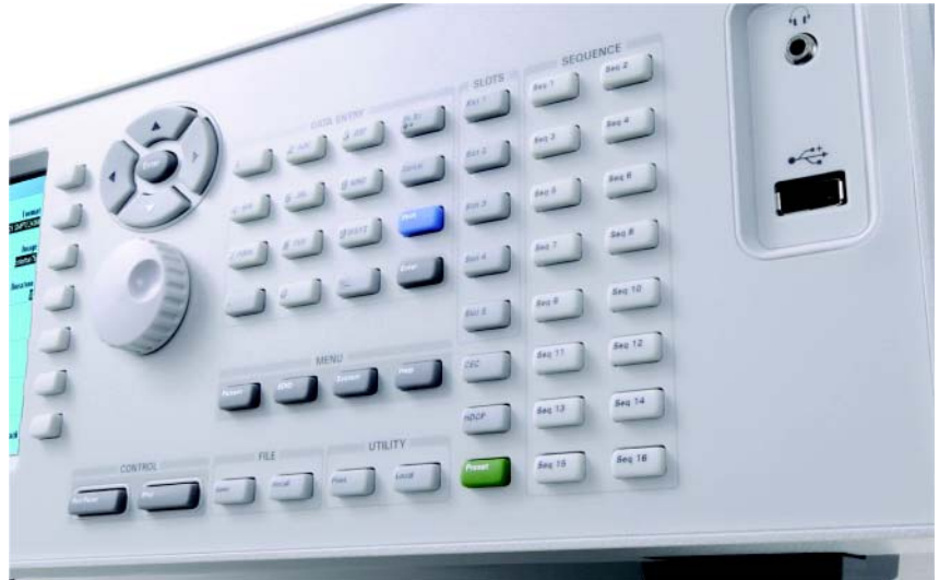
图 4. 热键提供常用功能的快速访问, 包括对 16 种测试配置的保存 / 调用
