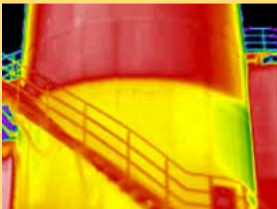
对储罐液位线进行快速二次校验
