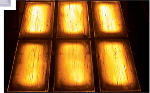
有破裂组件的CIS组串
