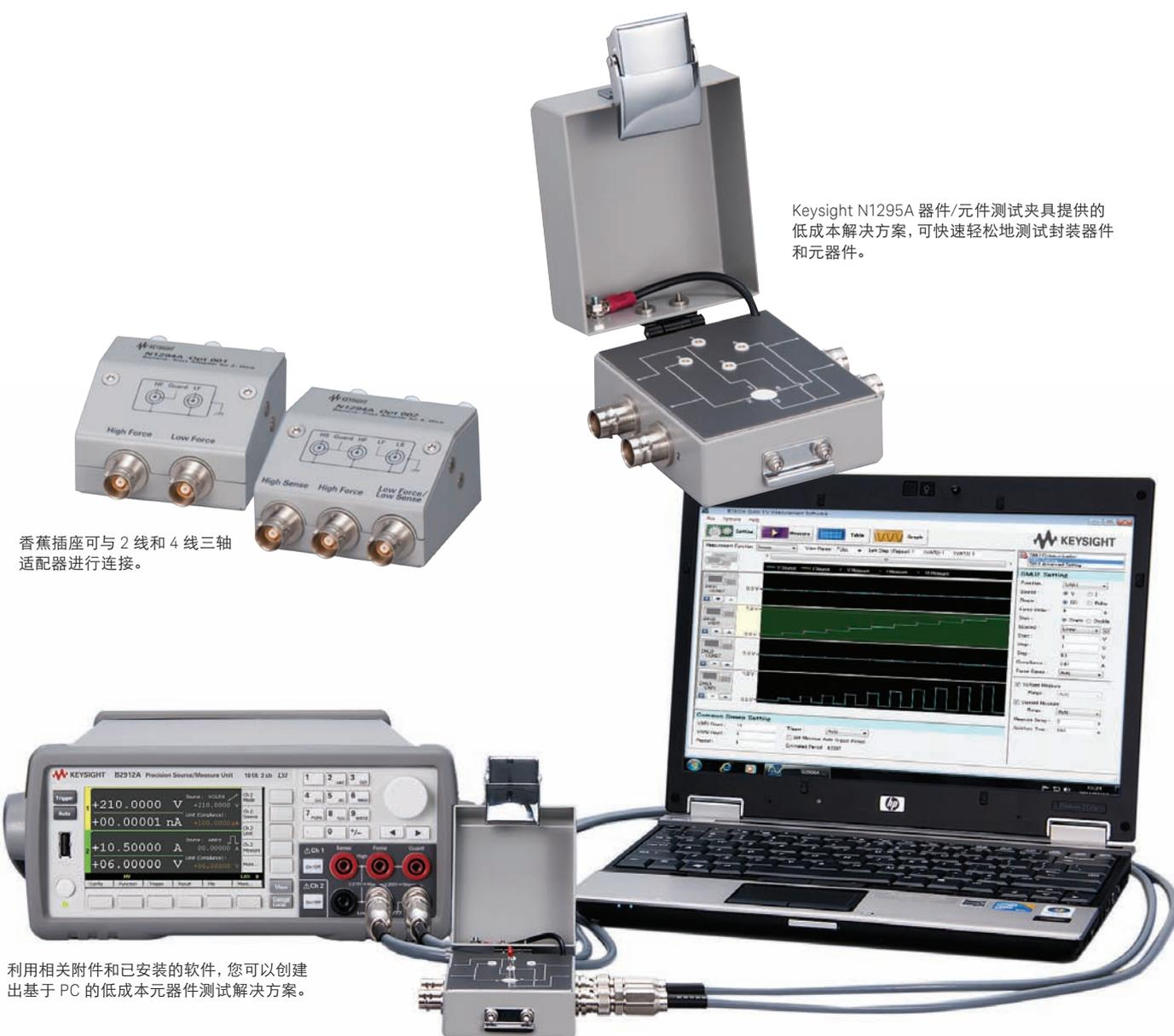
Keysight N1295A 器件/元件测试夹具提供的低成本解决方案, 可快速轻松地测试封装器件和元器件。
