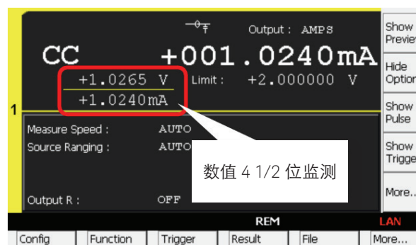
图 8. 在 4 1/2 位数值显示屏上进行快速状态检查
