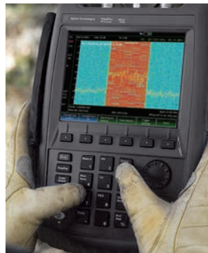
大按钮使用户即便戴着手套也能方便地执行频谱分析测量
