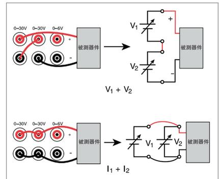
串联 30V 通道，把电压输出扩展到 60 V。并联通道，扩大电流输出容量。例如，把 2230G-30-6 的全部三条通道并联起来，输出最高 15 A 的电流。
