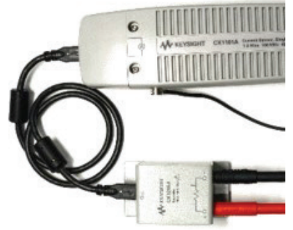
图 32. CX1206A 和 CX1101A。即使当您评测低功率器件时，您可能也会偶尔需要测量高于 1 A 的更大电流。CX1206A 传感器头配备扩展器，使 CX1101A 电流传感器以 ESL（等效串联电感）降低分流电阻技术为基础，测量从 3 mA 至 10 A 的电流波形。
