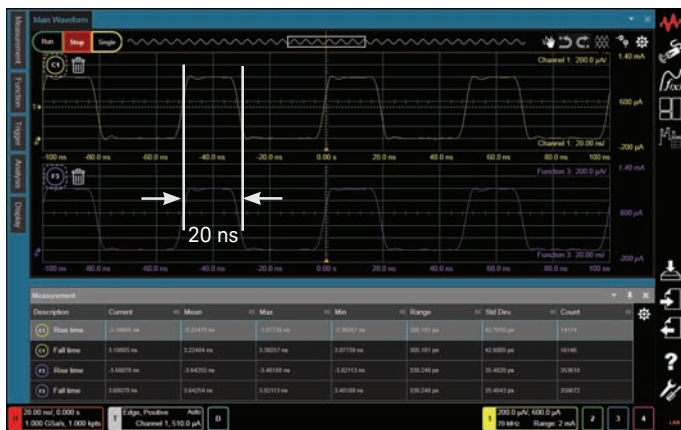
图 9. 您可轻松测量小于 100 ns 脉宽的瞬态电流，这将帮助您评测和分析两端设备，例如 PRAM、ReRAM、MRAM 等。
