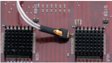
N5439A InfiniiMax III ZIF 探头焊接到 IC
