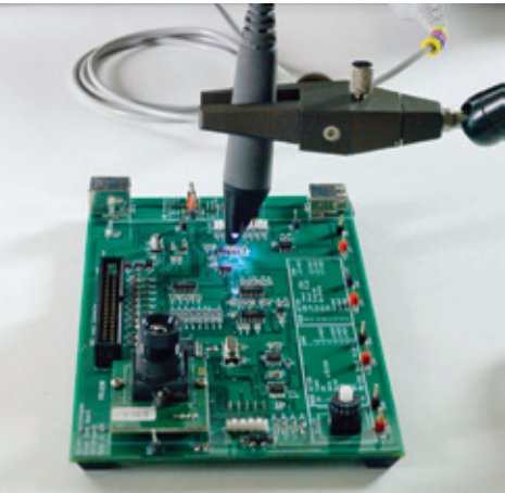
N2795A 1 GHz, N2796A 2 GHz 有源探头, 探头前端带有 LED 照明灯, 在探接被测对象时可更好地观察被测点
