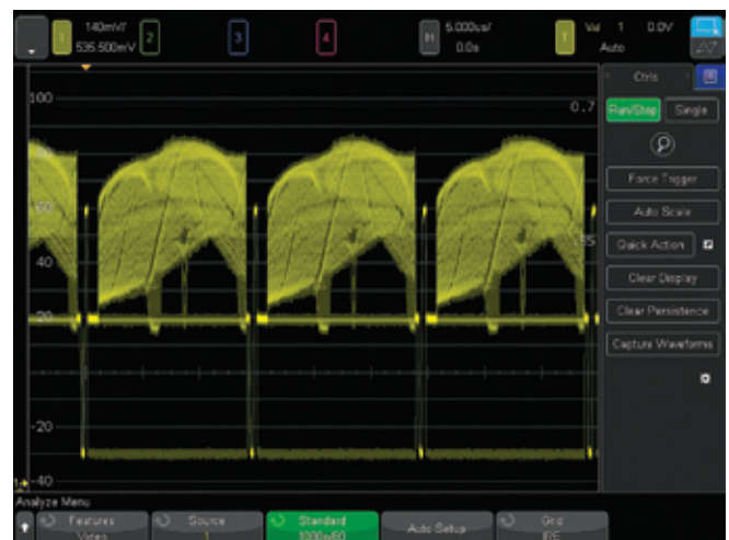
在 1080p HDTV 信号分析上进行触发
