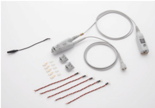
N2820A 探头, 当使用其用户自定义电阻前段时, 就变为—单端有源电压探头, 测量范围是 3 uV~1.2 V
