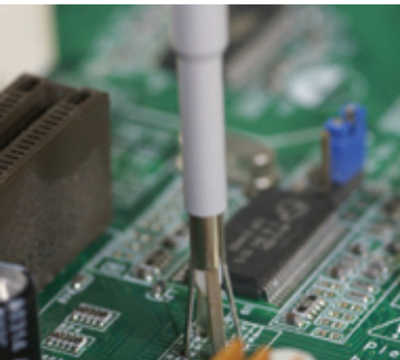
N2885A PCB 适配器配合 N2870A 系列无源探头使用
