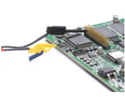
包含在 N2877A 和 N2878A 中的钩子 配合 N2870A 系列无源探头使用
