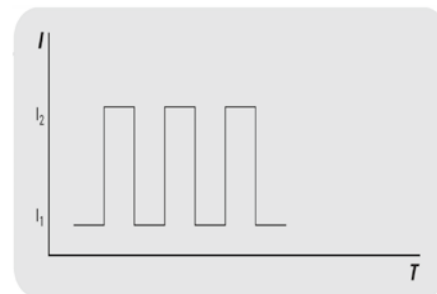
图5: 使用电子负载的脉冲充电要快得多，并可实现90%的重新充电。
