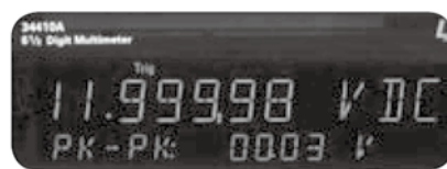
图3 可同时显示直流和交流测量结果的数字万用表例子
