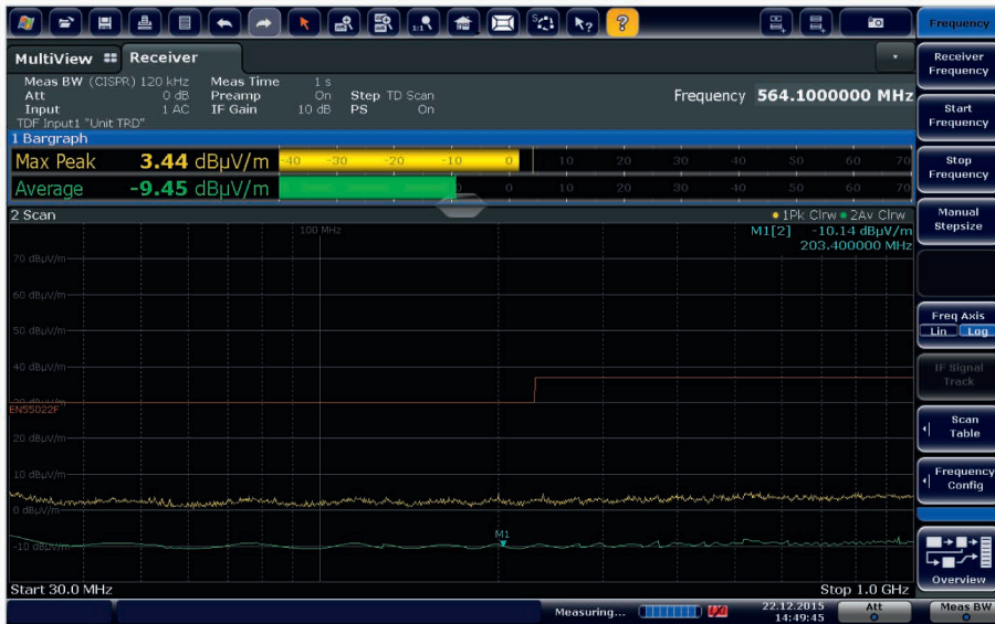
在频率到 1 GHz 时的显示平均噪声电平 (DANL)。开启前置放大器时的噪声系数约为 8.5 dB。
