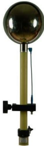
Van der Hoofden 测试头 VDDH 9502, 用于依据标准 DIN IEC 62493 (IEC 34/116/CD:2008) 和 VDE 0848-493, 测量照明设备对人体照射的影响。
