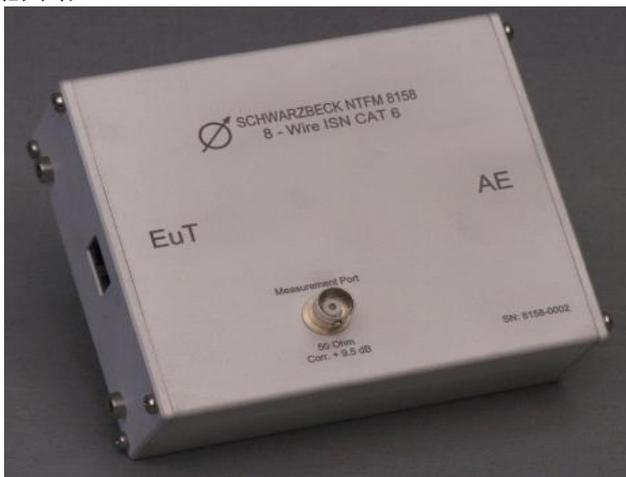
NTFM 8158 用于依据 CISPR 22 或 EN 55022, 测量非屏蔽双绞线 (UTP) 或具有 2/4/6/8 线的通信端口的骚扰电压。被测设备 (EUT) 或者辅助设备 (AE) 可使用 RJ-45 连接器进行连接, 引脚定义符合 EIA/TIA-T568A/B。NTFM 8158 的电路设计依据是 CISPR 22 版本 5.2 图 D. 3。
