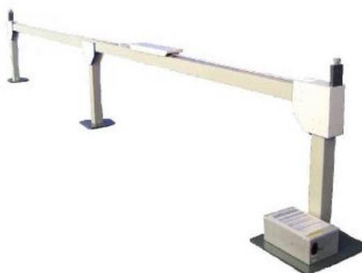
CGR 5.4 走行架 (自动滑轨), 除驱动单元外, 全部使用塑料 (PVC 和玻璃钢)。仅在基座和驱动机构有金属部件 (地平面上方最高 30cm)。
