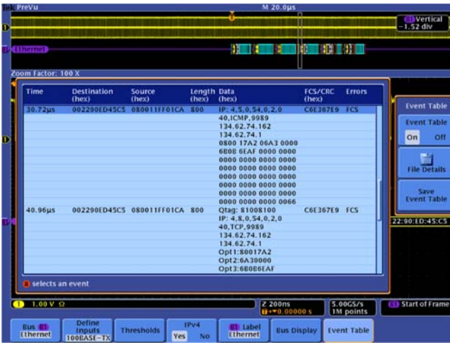
100BASE-TX 解码后的事件表，显示所有数据包信息及时间标记信息。
