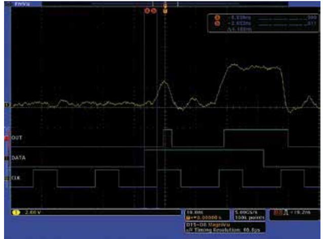
图 20. D 触发装置 Q 输出错误，包括模拟特点。
