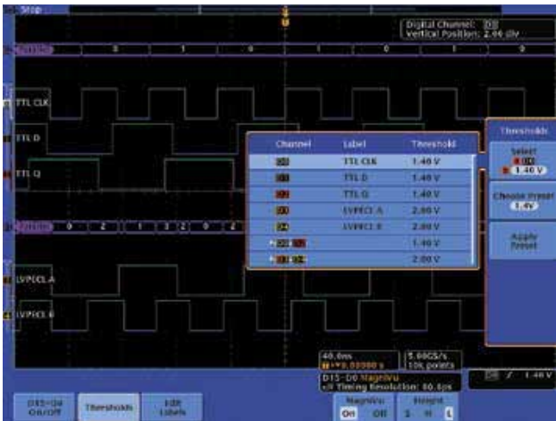
图 1. 同一个 MSO4000B 数字探头适配夹上的混合逻辑家族 (TTL & LVPECL) 门限设置。上面三条通道是 TTL 信号，门限为 1.40 V；下面两条通道是 LVPECL 信号，门限为 2.00 V。
