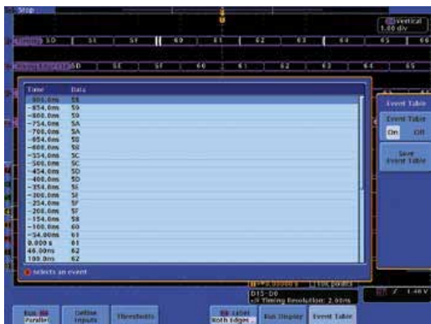
图 3. 在事件表中显示解码的数据，这与逻辑分析仪的状态采集显示画面类似。
