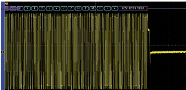
图 19. 10BASE-T 以太网帧末尾两位正 TP_IDL 信号证明差分探头正确连接到 10BASE-T 以太网双绞线上。
