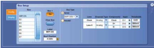
图 51. MIPI DSI-1 总线设置。
