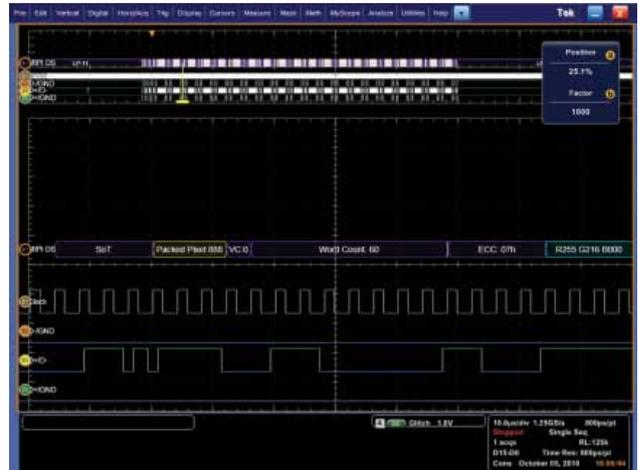
图 52. MSO70000C 数字通道解码后的封装像素流、24 位 RGB 8-8-8 格式长数据包显示画面。
