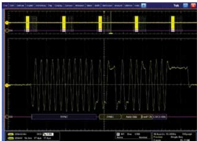
图 23. 使用配有选项 SR-USB 的 MSO5024 上的串行触发功能捕获的解码后的高速 USB 2.0 波形。
