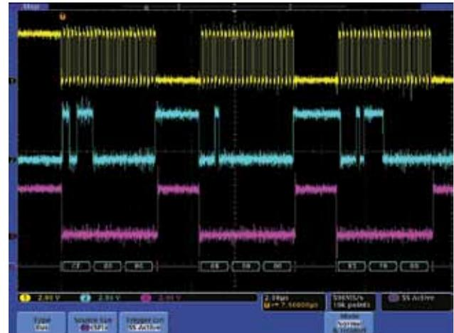
图 12. 采集 SPI 总线之外的合成器配置消息。
