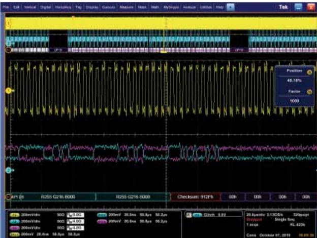
图 53. MSO70000C 模拟通道解码后的封装像素流显示画面，显示了校验和错误。
