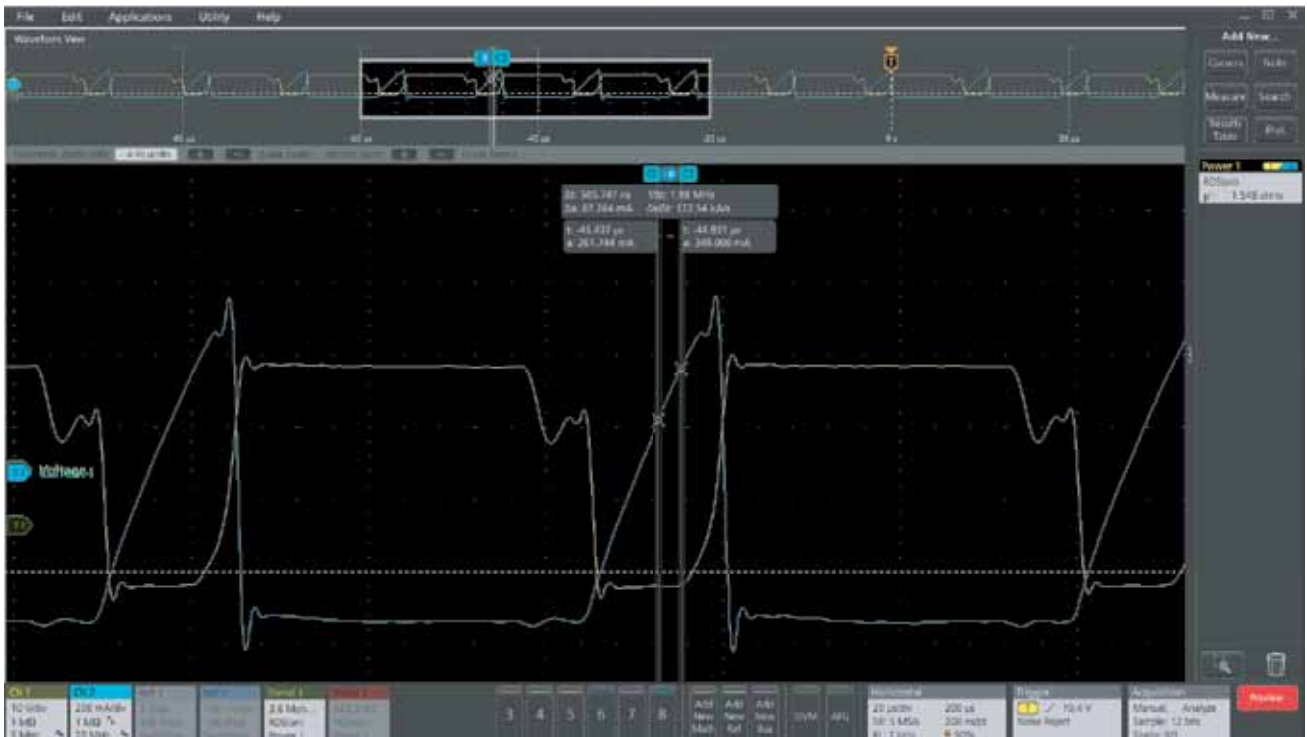
图 10. RDS(on) 测量。Ch1 (黄色) 波形是 FET VDS 电压, Ch2 (青色) 波形是 FET 电流。波形的相位颠倒, 以正确指明电流在传导区域中为高。结果标签 (右上方) 在默认情况下显示了中位数 RDS(on) 值, 但也可以配置成显示最小值。在本例中, 我们使用光标选通查找最小 RDS(on) 值, 其一般接近 1 欧姆 (图中为 1.58 欧姆)。
