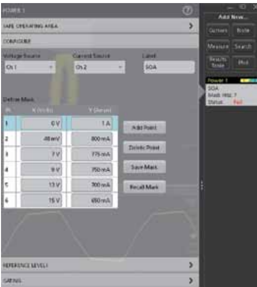
图 13. SOA 模板编辑器窗口。模板由一套（电压，电流）坐标确定，坐标来自开关器件产品技术资料，也可以由用户自己确定。
