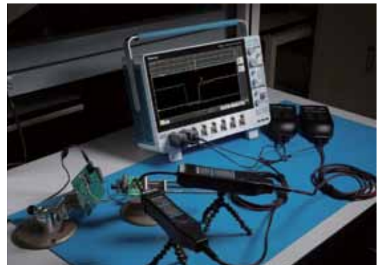
图 4. 许多电源拓扑要求在存在大的共模信号时测量小的差分电压。例如，半桥开关阶段高侧的 V_{GS} 和 V_{DS} 通常会相对于地电平上下移动几百或几千伏的电压。IsoVu™ 隔离测量系统可以与 5 系列 MSO 结合使用，提供超高共模抑制功能。
