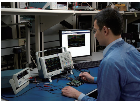
图 7: 在查看波形时，对 I 2 C 总线进行解码
