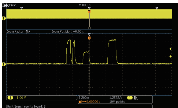
图 4: 矮波触发捕获的短脉冲
