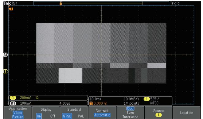
查看 NTSC 全彩条信号图像。视频图像模式包含了自动对比度和亮度设置以及手动控制。
