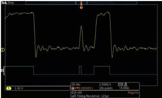
MagniVu 高分辨率记录提供 121.2 ps 的定时分辨率，可以在数字波形上进行重要的定时测量。
