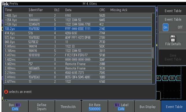
事件表显示长采集中每个 CAN 包解码的标识符、DLC、DATA 和 CRC。
