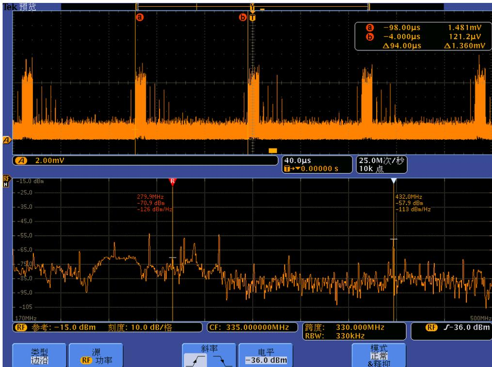
此时底噪明显下降，280MHz 处为-71dBm，当我们再将频谱分析时间段右移至完全没有突发幅度处时，得到如下测试结果：
