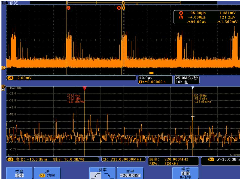
此时底噪已经降低到-85dBm 一下，原来 280MHz 频点处被底噪淹没的-73dBm 的信号此时已经显现出来。
