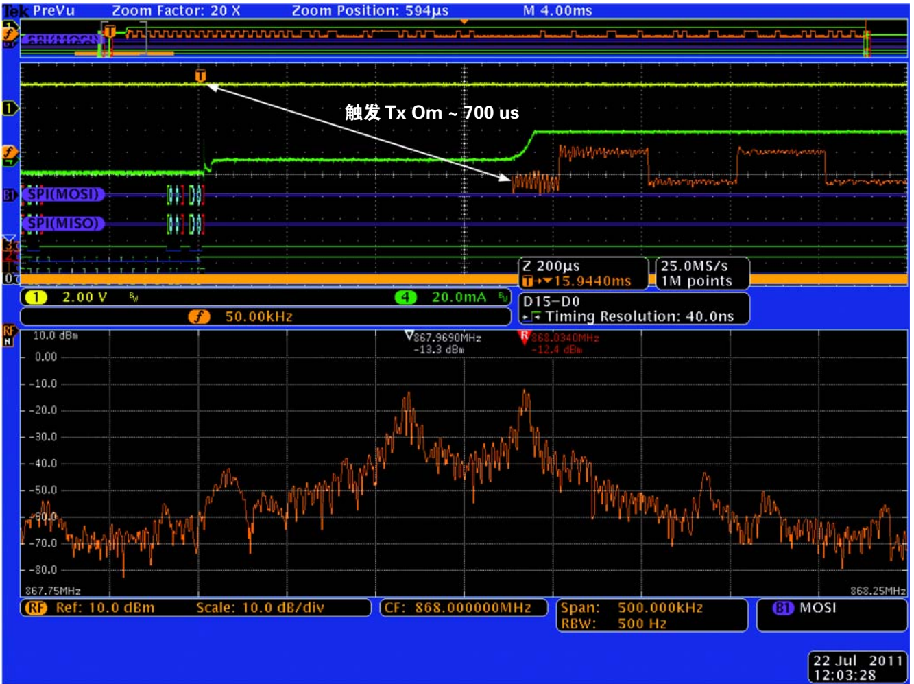
图 12. 触发 MOSI 命令，观察频率随时间变化曲线。
