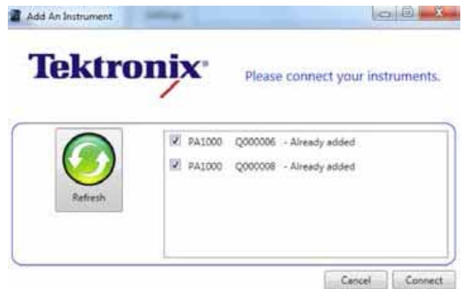
图 19. 通过 PWRVIEW 连接的两台 PA1000 实例。
