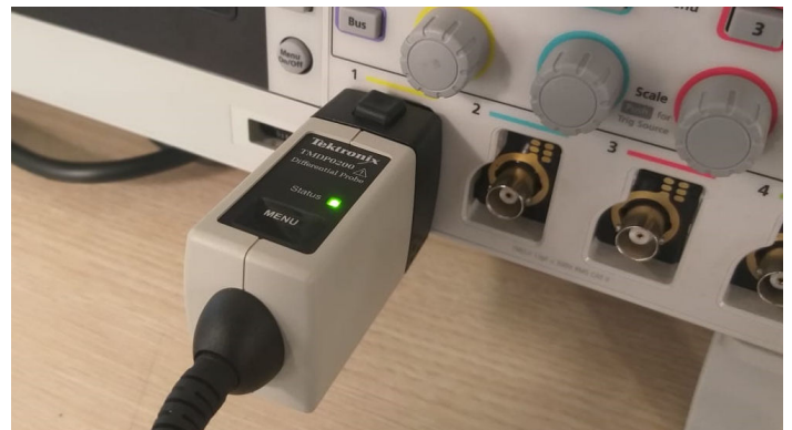
图9: TekVPI 探头把标度设置、量程和状态传送给 TBS2000B。
