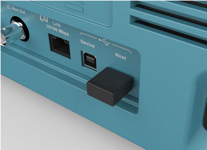
图 10: Wi-Fi 转接头通过集成设置菜单配置，支持无缝通信。
