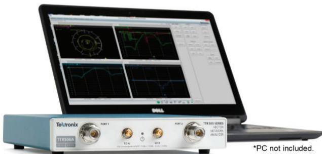
TTR500 每个端口有一个独立的 RF 源和三个 RF 接收机，可以对 1 端口或 2 端口被测器件 (DUT) 获得高精度幅度和相位测量。可以使用 TTR500 对 DUT 执行全面的 S11、S12、S21 和 S22 测量，以各种格式显示数据 (参见测量功能表)。
