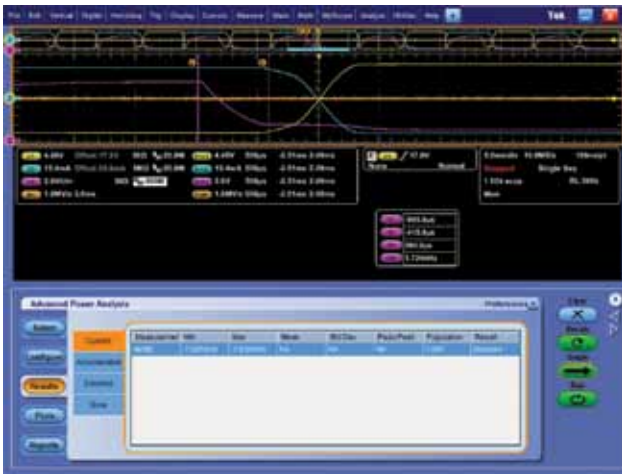
图 7. 自动测量 MOSFET 栅极转换速率。
