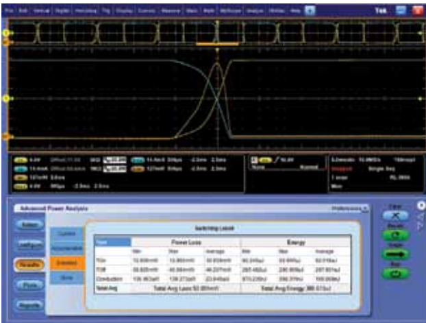
图 5. DPOW 自动开关损耗测量。
