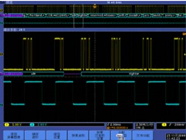
图 4. 黄色的 RS232 波形被自动解码同时测试到一组时钟信号
