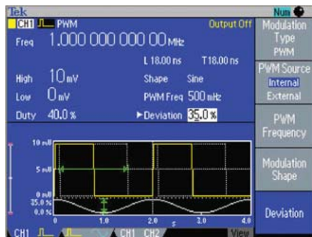
图 6. AFG3000 的 PWM 信号输出功能
