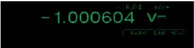
图 4. 使用 DMM4000 数字表的双参数测量功能测试纹波
