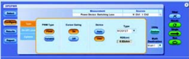
图 7. DPOWPR 输入页面允许用户输入 R_{DSon} 和 V_{CEsat} 的产品技术资料值。
