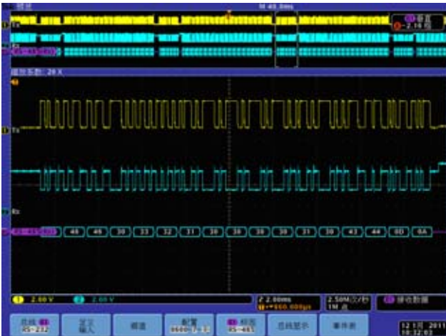
图 7. RS485 总线的触发和解码
