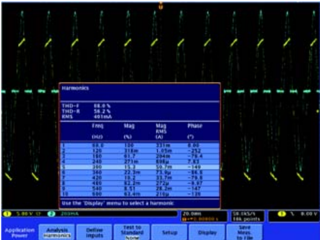
图 11. 使用 DPOxPWR 进行谐波分析。
