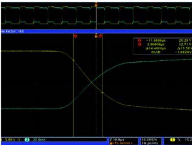
图 15. 使用 DPOxPWR 进行转换速率测量。
