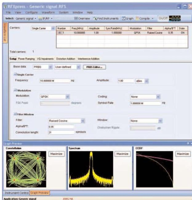
图 39. RFXpress 创建的单载波 RF 波形。
