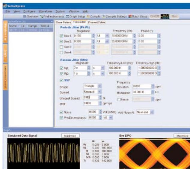
图 38. SerialXpress 可以轻松生成损伤信号。
