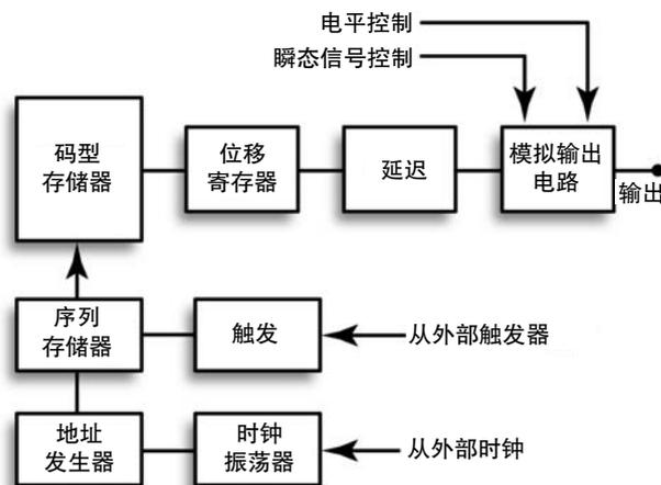
图 41. PPG 或 DTG 的结构 (简图)。
