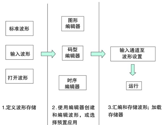
图 35. 使用 AWG 创建波形的基本步骤。
