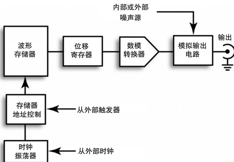
图 18. 任意波形发生器的结构(简图)。
