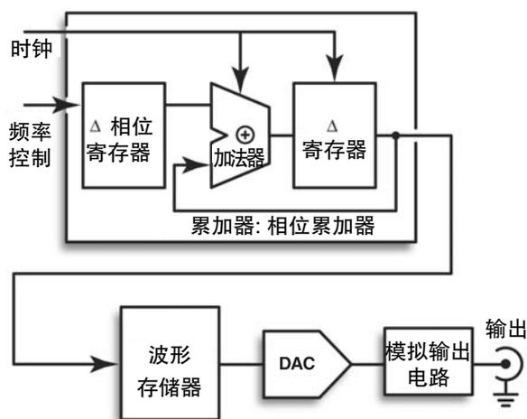
图 16. 任意波形 / 函数发生器的结构(简图)。
