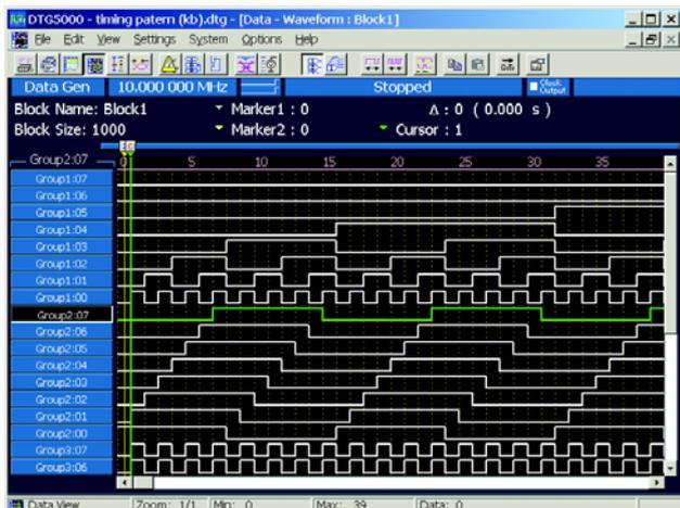
图 46. 多通道 DTG 的总线定时显示画面。
