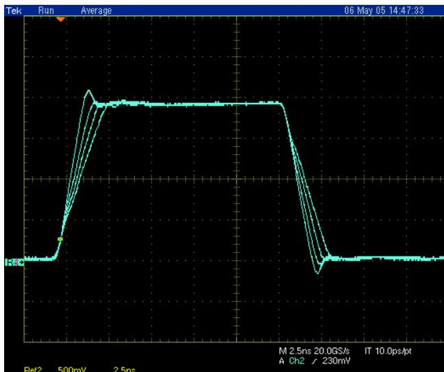
图 44. 码型发生器输出信号上的程控上升时间变化。
