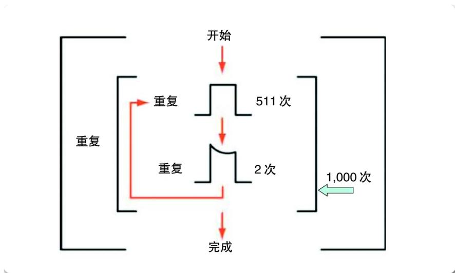
图 32. 可以使用循环和重复扩展 AWG 的波形存储器容量。
