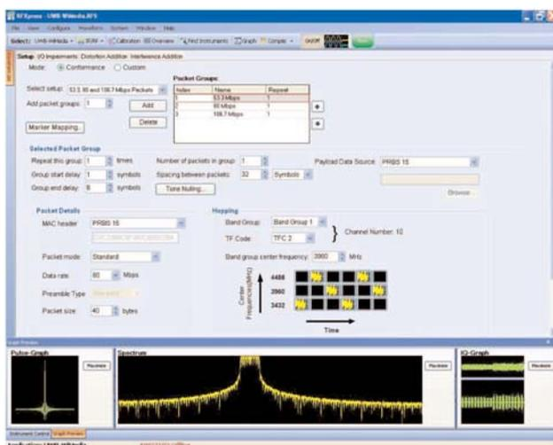
图 40. 使用 RFXpress 创建的复杂的 UWB 波形。
