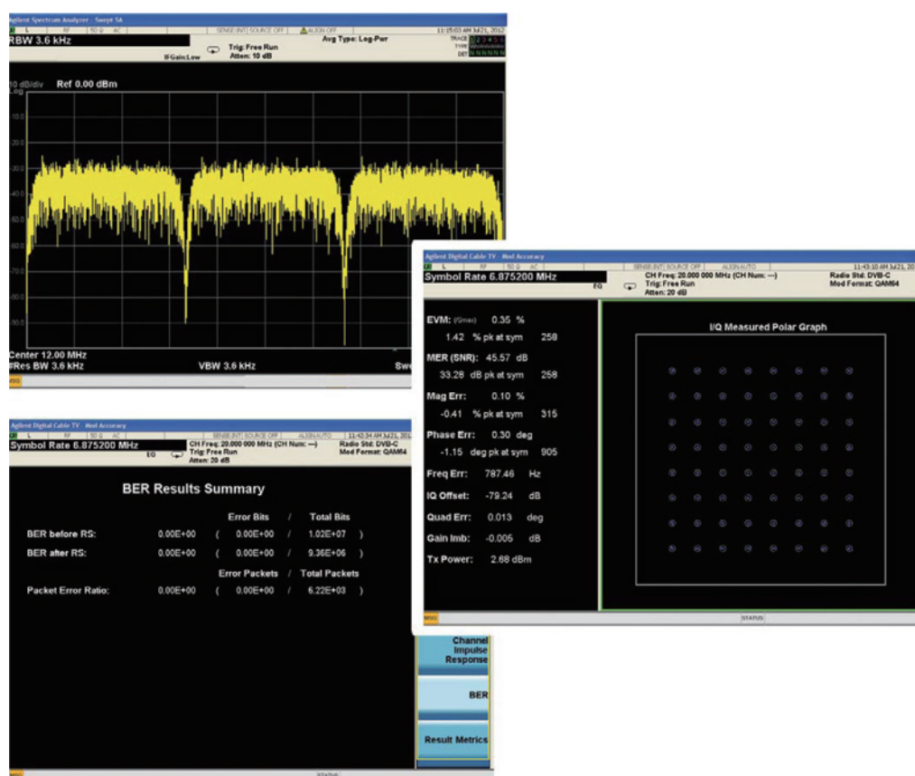
图 11. Agilent 33522B 同时生成 3 个 DVB-C 64QAM 载波。在中心信道中执行测试，所有信道根据 DVB-C 标准进行编码——但数据不能避免在合成信号中人为地出现大功率峰值。DVB-C 分析显示了所得的调制质量 (EVM = 0.35%)。由于信号已经过了恰当的信道编码，可用于执行 BER 测试。通过检测解码之前和之后的校正误差和未校正误差，可以计算出 BER。
