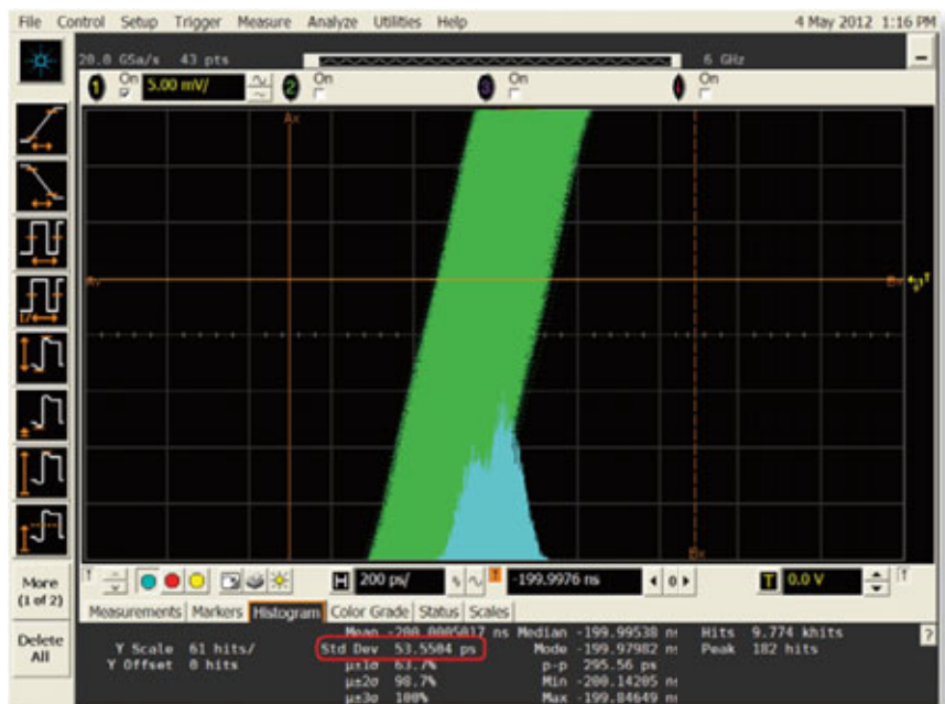
图 4. 对 DDS 信号的抖动测量。
