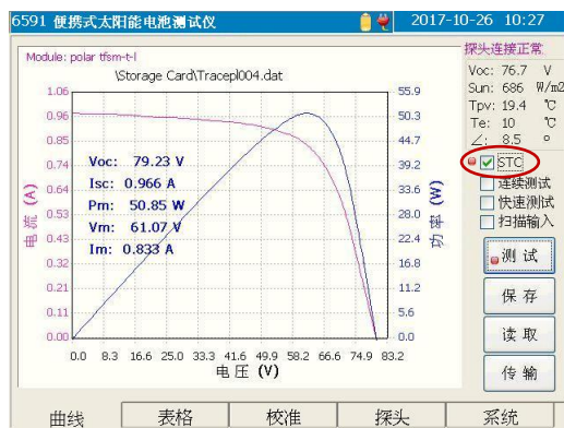
转换为 STC 下的测试曲线
