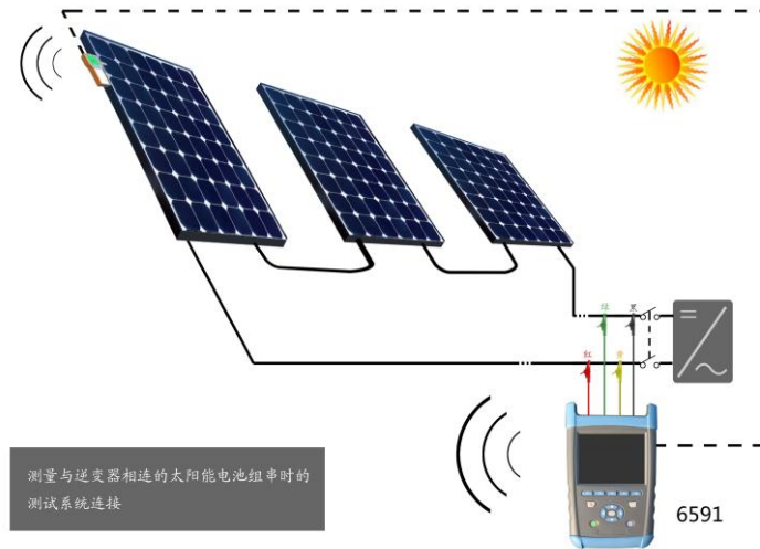
图 4-7 光伏电站中电池组串测试示意图
