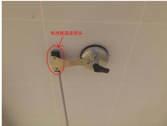
图 4-3 方形温度探头安装示意图
