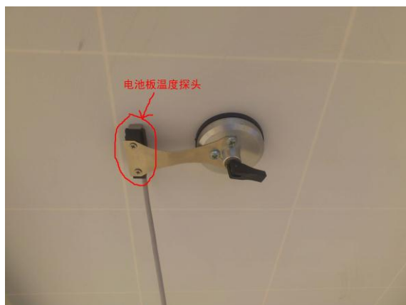
图 4-3 方形温度探头安装示意图
