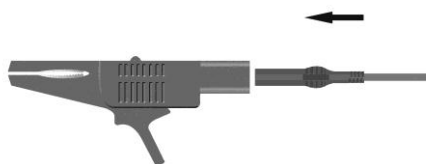
图 4-5 测试线与鳄鱼夹连接示意图
