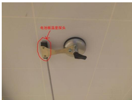
图 3.5 方形温度探头安装示意图
