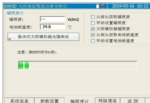
图 4.16 脉冲式太阳模拟器光强测试示意图
