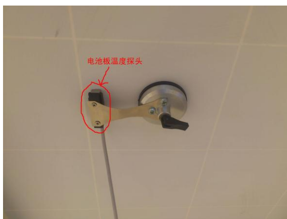
图 4-3 方形温度探头安装
