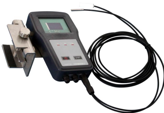
图 4-1 太阳辐照度计固定
