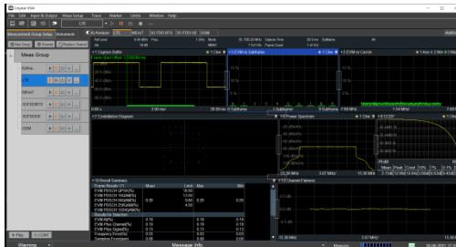
支持 3GPP LTE 和 LTE-Advanced 带内测量。通过自动检测来提供便利分析功能。所有信号子帧都将进行分析，且 QPSK、16QAM、64QAM 和 256QAM 调制格式以及循环前缀长度会在分析中自动检测并应用，极大降低了用户设置工作量。
