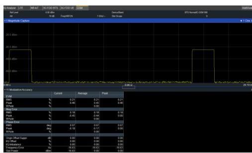
支持测量符合标准的 GSM、EDGE 信号。根据标准自动配置有关调制频谱及开关瞬态频谱的测试限值以及随时间变化的功率测试限值。
