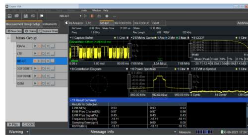
支持 3GPP 针对基站和用户设备指定的窄带 NB-IoT 的解调分析测量。支持 Standalone 部署以及在标准 LTE 载波“带内”和“带外”部署。
