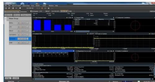
支持对 3GPP WCDMA 上行链路和下行链路的带内测量。支持码域功率测量。
