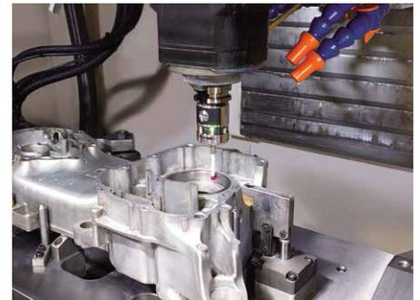
使用高速跳转功能进行测量的示例
