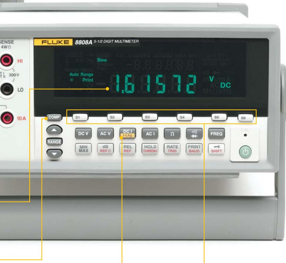
i-Lkg 功能，为灵敏的小电流测量额外增加了两个低阻抗量程。
