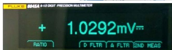
图 1 Fluke 8845A/8846A 比率测量功能
