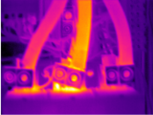
利用热像仪发现三相不平衡的负载
