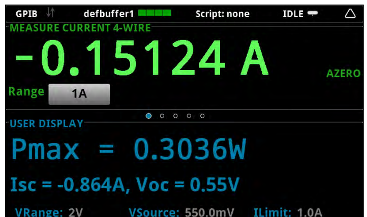
图8 2450型仪器显示屏显示最大功率( P_{max} )、短路电流( I_{sc} )和开路电压( V_{oc} )
