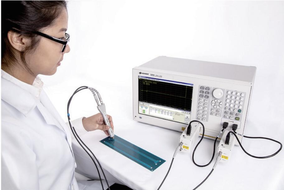
E5063A PCB 分析仪包含 E5063A ENA 系列网络分析仪以及选件 O11 (时域分析/测试向导)。E5063A 提供频域测量功能，选件 O11 添加了时域分析功能，并提供了专为 PCB 生产制造而设计的独特的图形用户界面。
