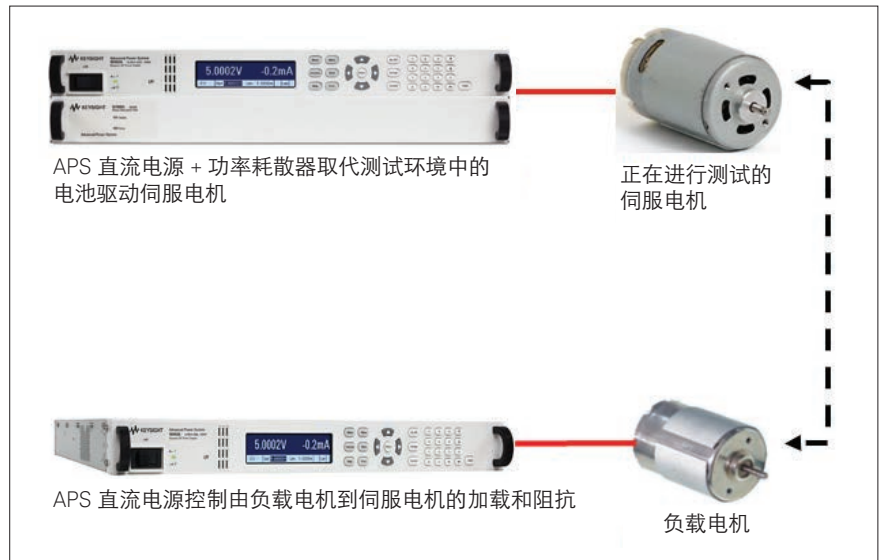
伺服电机测试：功率耗散吸收再生能量，以防止过度的反电动势
