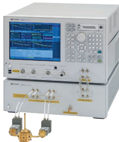
E5052B 信号源分析仪及 E5053A 下变频器加 11970 谐波混频器
