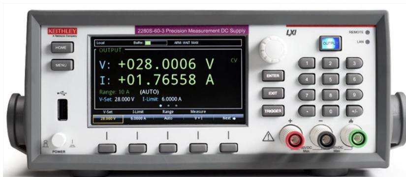
PMS 2280S 提供共四个电流测量量程，电流测量分辨率最高为10nA，电流测量精度最高精度可以达到0.05% + 10μA。可以应对待测件各种幅值的电流测量要求。另外提供的积分测量功能，通过设置积分时间，可以有效的消除工频以及各种倍频信号对直流测量的干扰，使直流测量更加准确。
