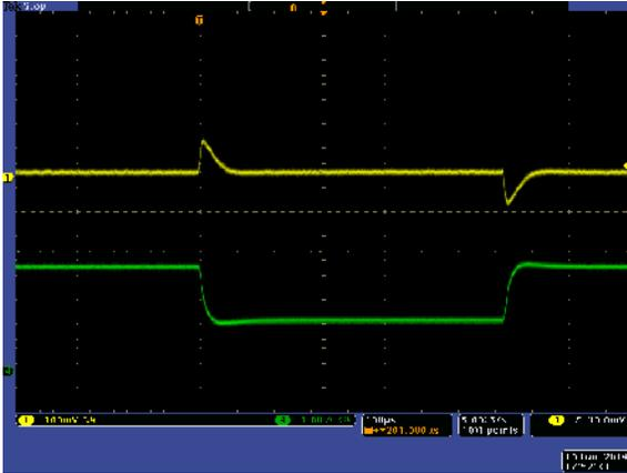
负载电流跳变时，输出电压的波动
