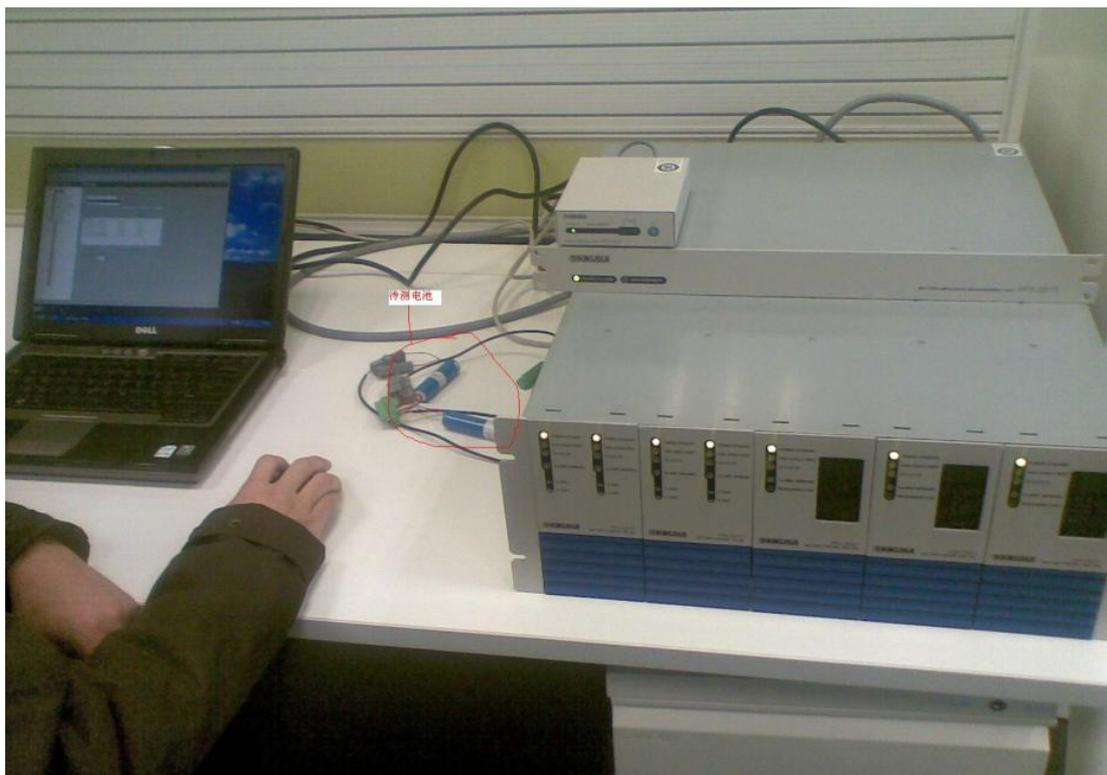
应用比较简单, 通过菊水这套系统测试出电池的充放电曲线、阻抗变化曲线、容量等, 通过多次充放电测试, 可评估出电池的寿命等特性。
