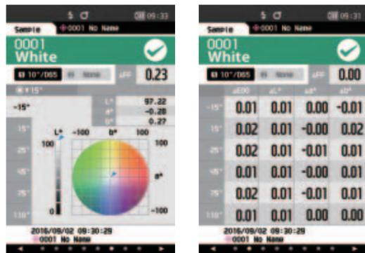
CM-M6配备了一块内置3.5英寸彩色LCD，既可通过数字来显示测量值，也可通过彩色图形来显示测量值，从而使显示结果更加形象。
